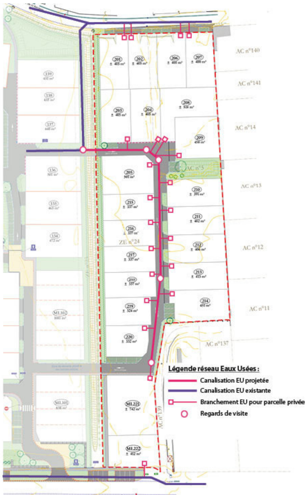
Schéma du réseau EU projeté - AMENAGEO - Janvier 2025
